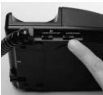
Afbeelding 4: De instelknop AARDE/FLASH aan de linkerkzijde van het toestel.
